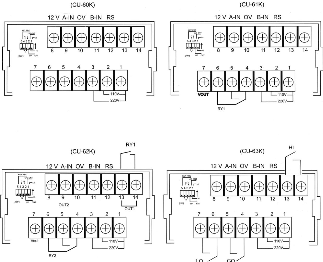
Vout: NPN電壓出力,可直接驅動SSR……。
